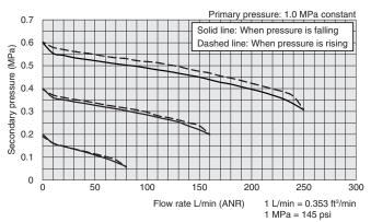
■ Pressure characteristics Note 1 RTLP4-M5, RTLP4-M5-G RTLP6-M5, RTLP6-M5-G
